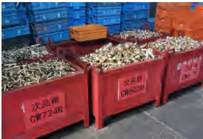
步骤一：回收机械加工产生的铜沫与不良品
